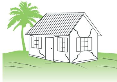
Figure 17 : Rupture des murs résistants (séisme)
