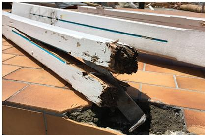
Figure 6 : Poteaux avec équerres arrachées
