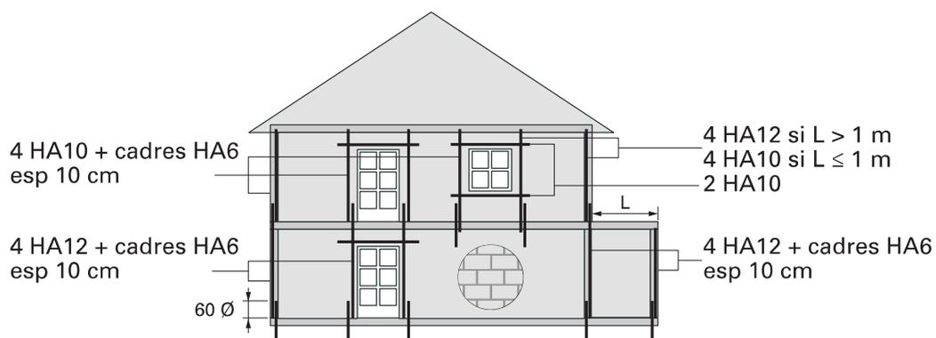
Figure 19 : Exemple de disposition des chaînages verticaux
